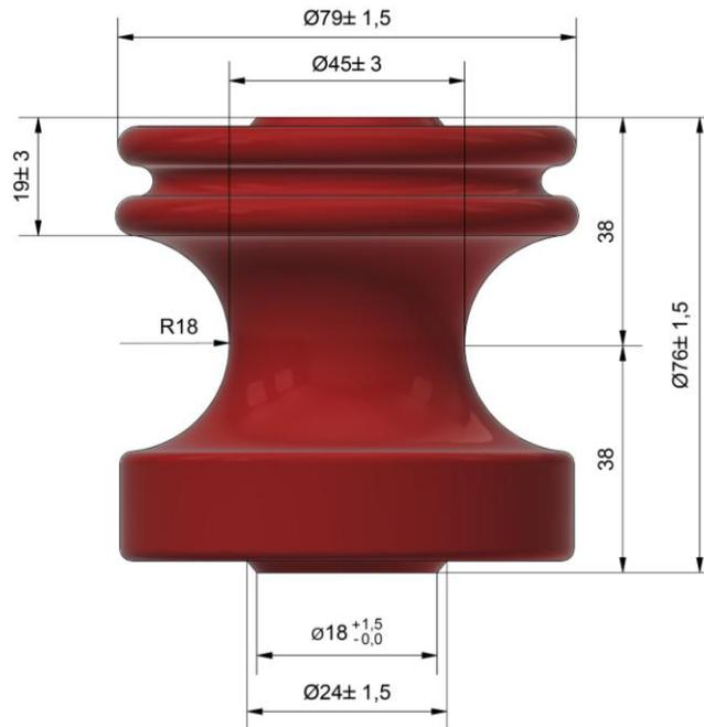
**Figura 1** - Isolador Roldana Tipo 1 – Porcelana – ABNT R1350-2
