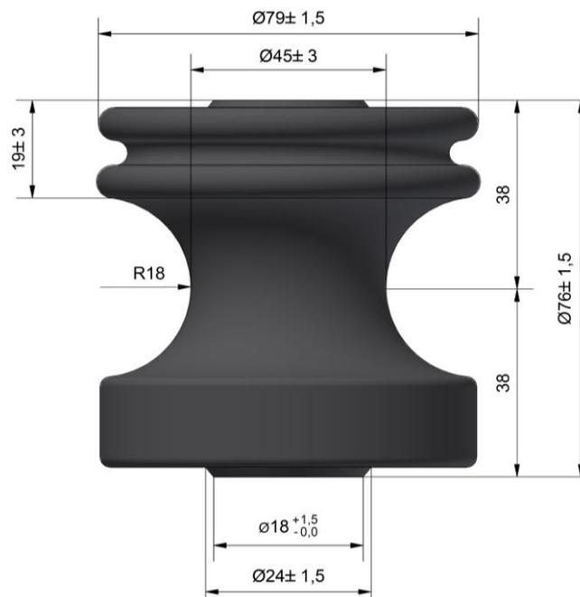
**Figura 2** - Isolador Roldana Tipo 2 – Polimérico – Equiv. ABNT R1350-2
